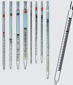
La pipette graduée est moins précise que la pipette jaugée et ne doit donc être utilisée que pour transférer des volumes pour lesquels il n'existe pas de pipette jaugée.
