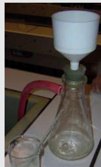
L'entonnoir Büchner est un équipement de laboratoire utilisé pour la filtration sous vide.
