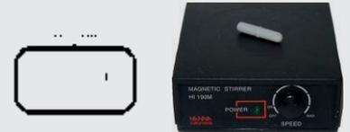
Il permet d'homogénéiser un mélange de façon automatique. Ainsi, il est très utile pour les agitations qui durent longtemps comme pour la préparation d'une solution à partir d'un composé solide qui se dissout difficilement ou les dosages conductimétriques ou pH-métriques.
